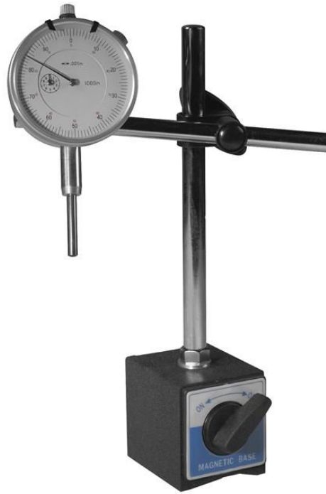
شكل رقم ٧٤: تثبيت ساعة القياس على قاعدة قياس مغناطيسية مستوية
