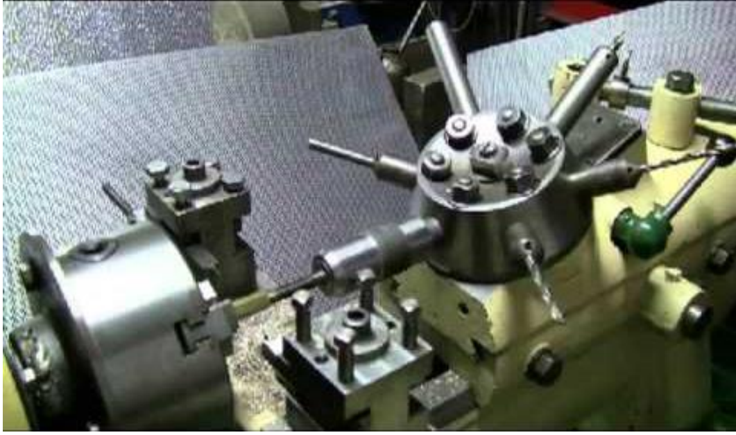
شكل رقم ١١: مخرطة البرج لإنتاج أجزاء صغيرة Small precision manually operated
