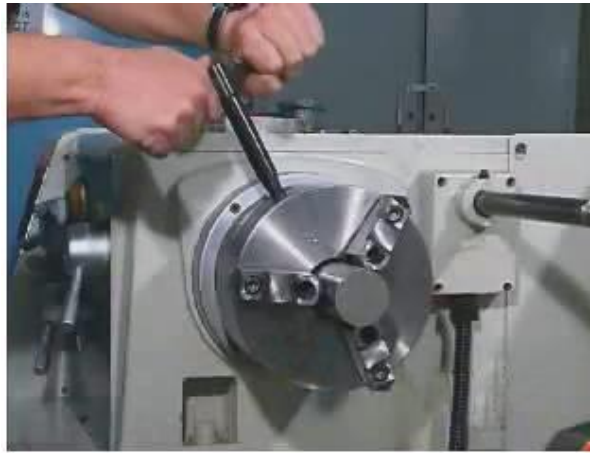
شكل رقم ٦٦: ربط المشغولات باستخدام مفتاح الظرف
