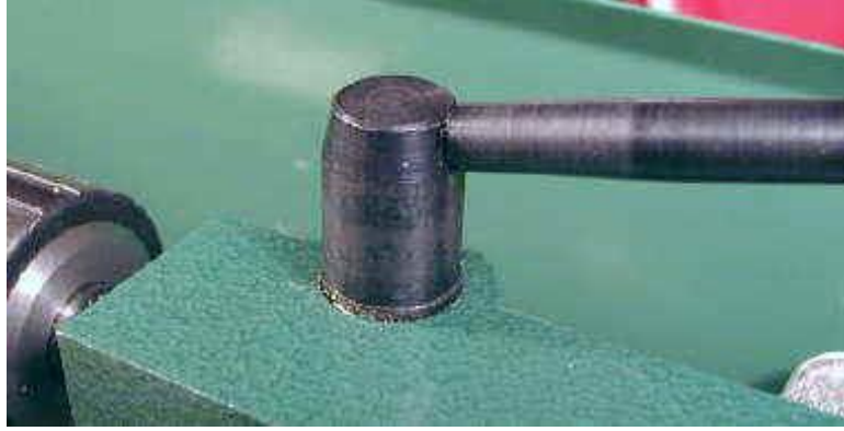
شكل رقم ١٢٧: ربط ذراع تثبيت الذئبة الدوارة
