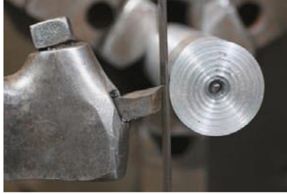
شكل رقم ١٠٣: ضبط نقطة البداية للقلم مع الشغلة
