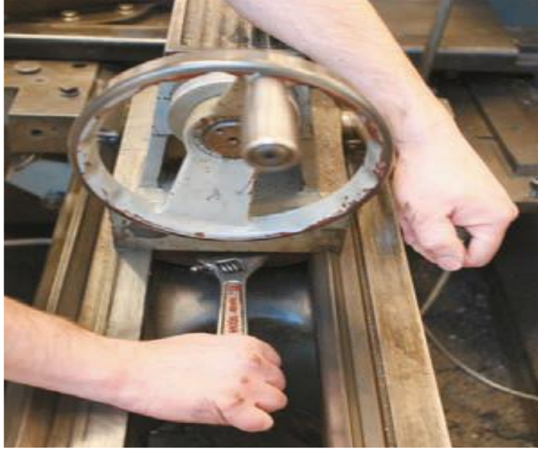
شكل رقم ٥٦: طريقة ربط مسمار تثبيت الغراب المتحرك
