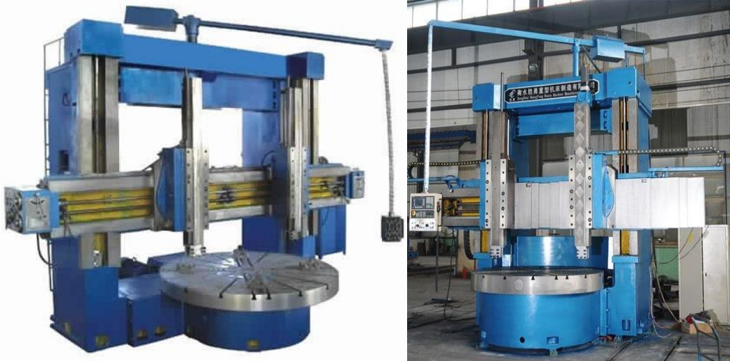
شكل رقم ٨: المخرطة العمودية A vertical boring mill
