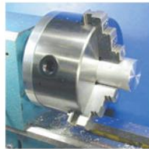
شكل رقم ٦٧: تركيب المشغولات على الظرف بفكوك متدرجه للخارج
