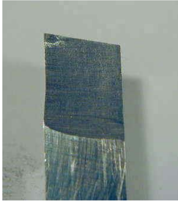
شكل رقم ١٤٦: قلم ذو حواف حادة مربعة مسنون بزوايا أقل من ٩٠ درجة
