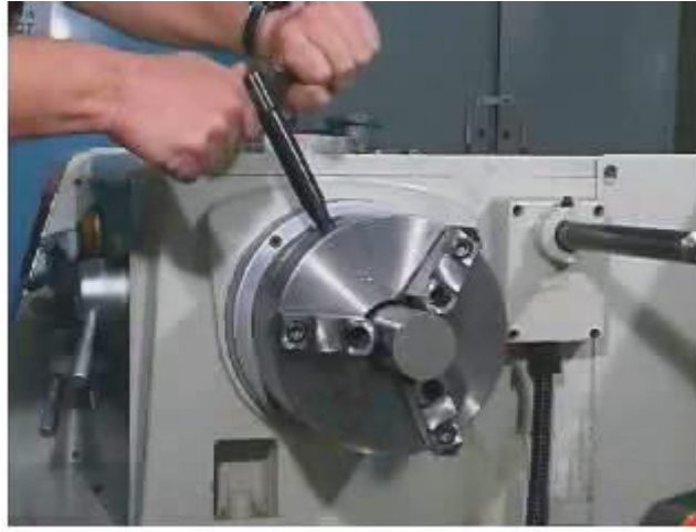
شكل رقم ١١٣: ربط الشغلة في الظرف وربطها في الظرف بدون قوة
