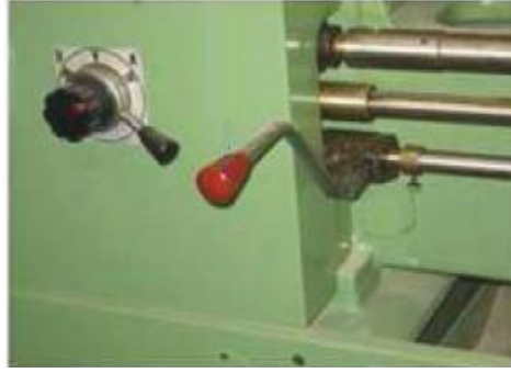
شكل رقم ١٣٥: وضع ذراع التشغيل في الوسط لفص حركة الظرف عن الموتور
