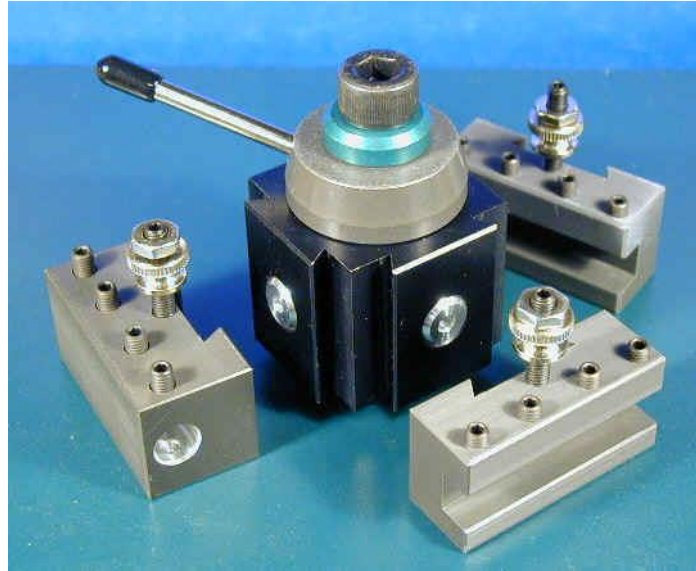
شكل رقم ٣٤: أداة تثبيت سريعة التغيير (زيل حمامة) متعددة المواضع
