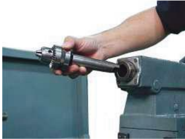
شكل رقم ٦٣: تركيب ظرف المثقاب
