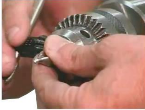
شكل رقم ٦٥: مفتاح ربط ظرف المتقاب
