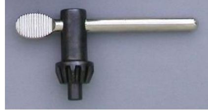
شكل رقم ٦٥: مفتاح ربط ظرف المتقاب
