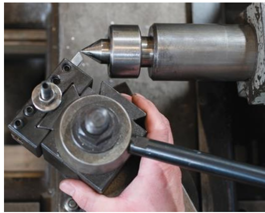
شكل رقم ١١٨: ضبط طرف رأس لقلم مع مركز الذنبة
