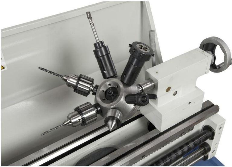
شكل رقم ٥٢: برج الغراب المتحرك لتثبيت أدوات مختلفة لعمل وظائف مختلفة
