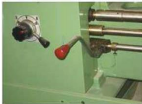
شكل رقم ١٤٩: وضع ذراع التشغيل في الوسط لفص حركة الظرف عن الموتور
