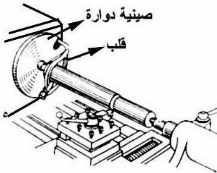
شكل رقم ٣٦: الصينية الدوارة وتثبيت الشغلة عليها
