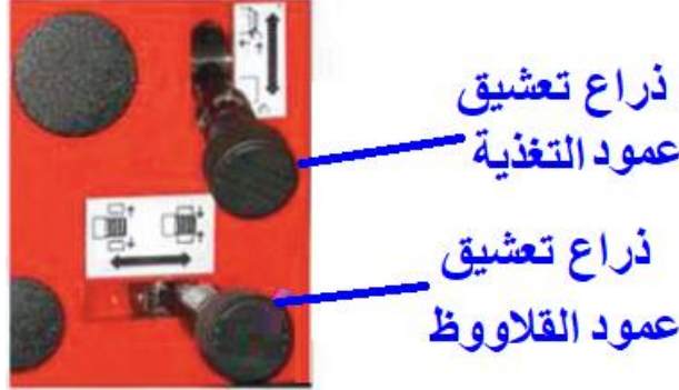
شكل رقم ٨٤: اذرع تعشيق القلاووظ والتغذية لبعض موديلات المخارط
