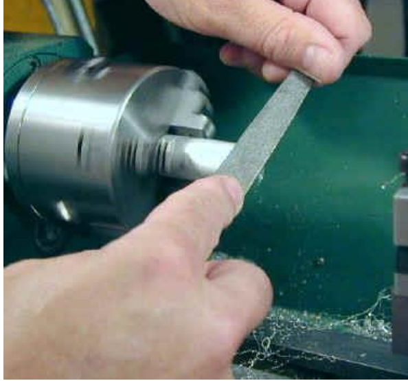
شكل رقم ١٢٤: استخدام مبرد لإزالة الحواف الحادة
