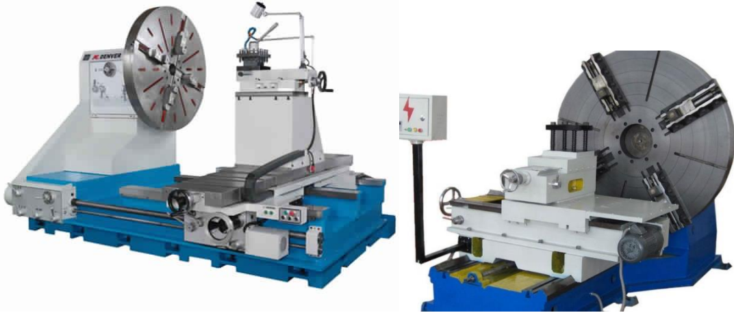
شكل رقم ٧: مخارط وجهيه Face lathe
