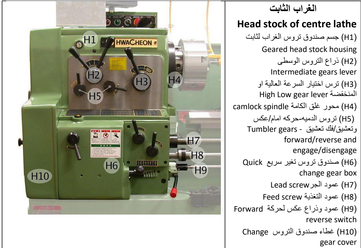
شكل رقم ٢٠: مكونات الغراب الثابت
