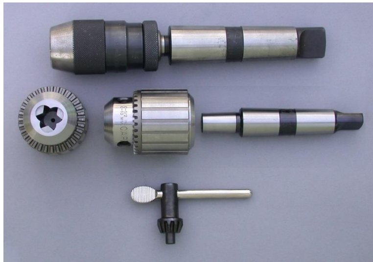
شكل رقم ٤٩: ظرف المثقاب بمسلوب مورس
