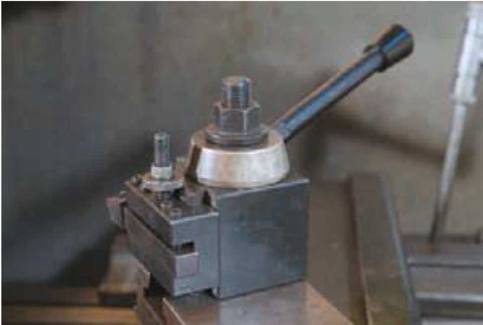
شكل رقم ٣٣: أداة تثبيت سريعة التغيير
