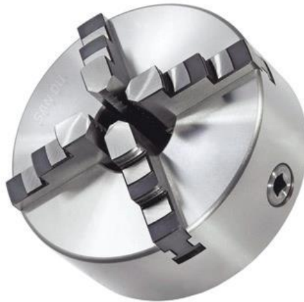
شكل رقم ٣٨: الظرف الرباعي المركزي
