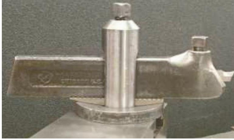
شكل رقم ١٠٨: ربط القلم في المقلمة الأحادية
