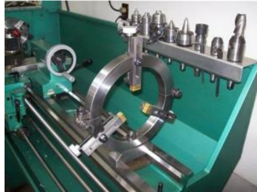
شكل رقم ٤٢ : مكان تثبيت المخنقة الثابتة على فرش المخرطة
