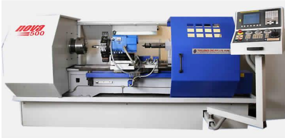
شكل رقم ١٣: المخرطة المبرمجة بالحاسب CNC lathe
