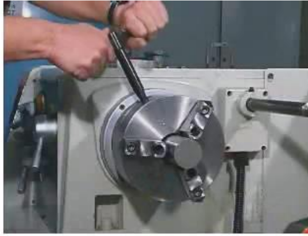
شكل رقم ١٥٠: ربط الشغلة في الظرف وربطها في الظرف بدون قوة
