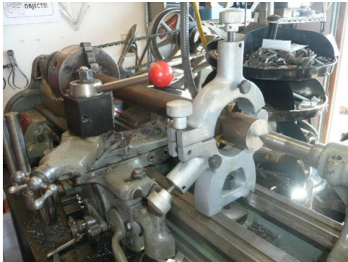
شكل رقم ٤٢ : مكان تثبيت المخنقة الثابتة على فرش المخرطة
