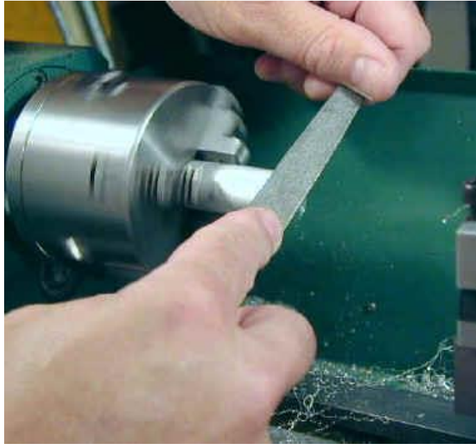
شكل رقم ١٤٨: استخدام مبرد لإزالة الحواف الحادة
