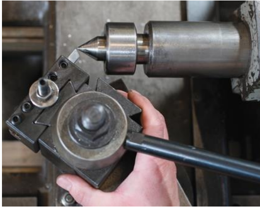
شكل رقم ١٠٠: ضبط مركز الذنبه مع سن القلم
