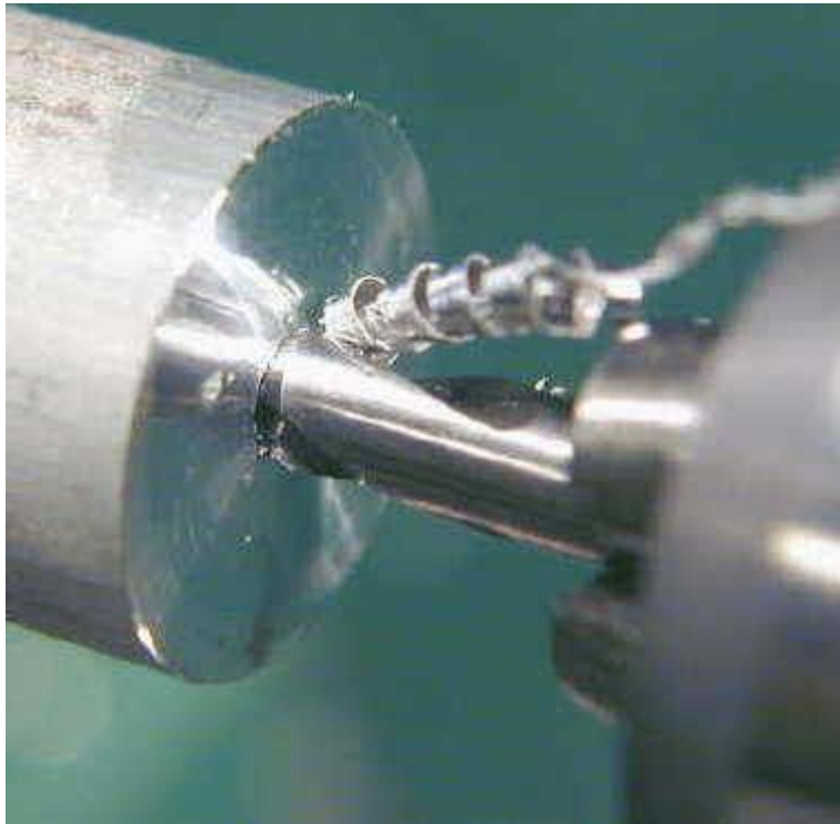
شكل رقم ١٣١: اختراق \frac{4}{3} طول الجزء المخروطي لبنطة العلام في الشغلة
