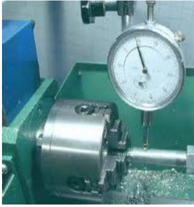
شكل رقم ٧٦: فحص مركزية الأعمدة الأسطوانية باستخدام مبيّن ساعة القياس
