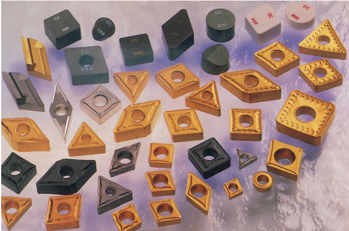
شكل رقم ١٨: أنواع وأشكال وأحجام مختلفة من لقم الخراطة
