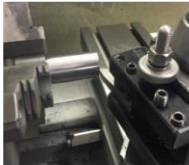
شكل رقم ١١٩: امالة القلم على سطح الشغلة بزاوية ٢ الى ٣ درجة
