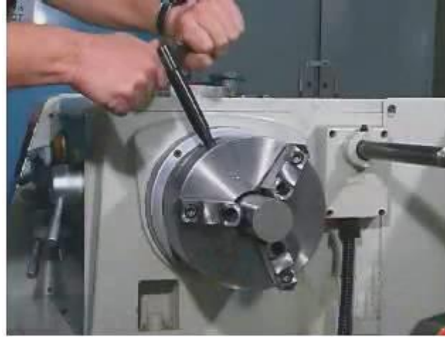
شكل رقم ١٣٦: ربط الشغلة في الظرف وربطها في الظرف بدون قوة
