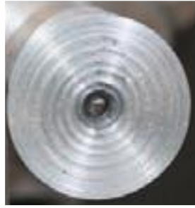
شكل رقم ١١٧: حلقات نتيجة استخدام قلم حاد وتغذية كبيرة عند عمل التسوية
