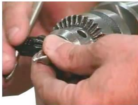
شكل رقم ١٢٩: ربط الذئبة باستخدام مفتاح الظرف
