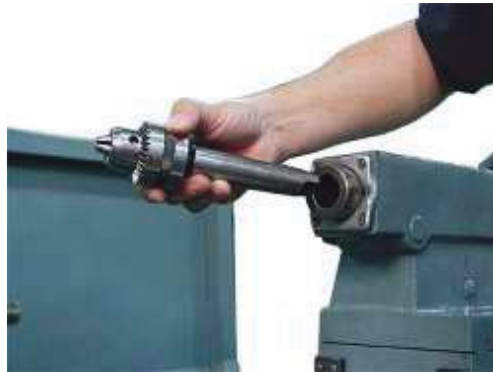
شكل رقم ١٢٦: تركيب ظرف المثقاب
